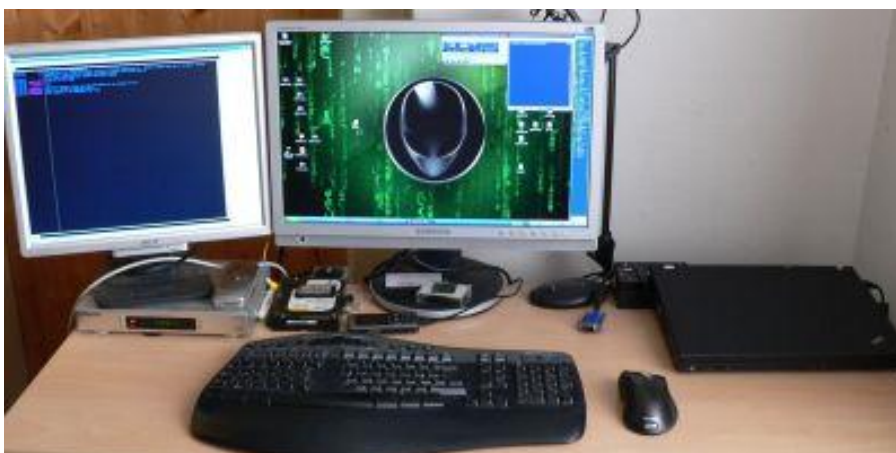
Obrázok 6: Externé monitory, klávesnica a myš pripojená k notebooku pomocou dokovacej stanice.
