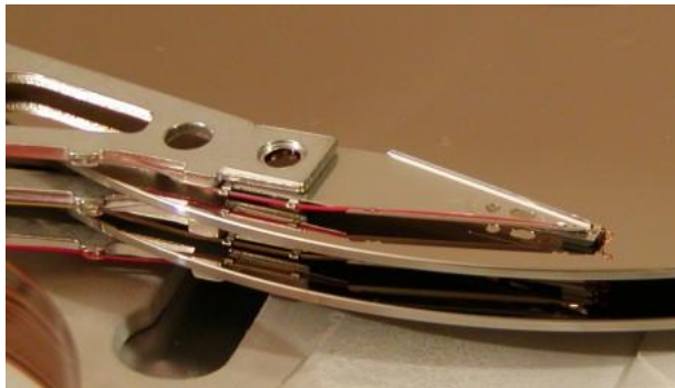
Obrázok 2: Detailný pohľad na ramená disku s čítacími a zapisovacími hlavami.
